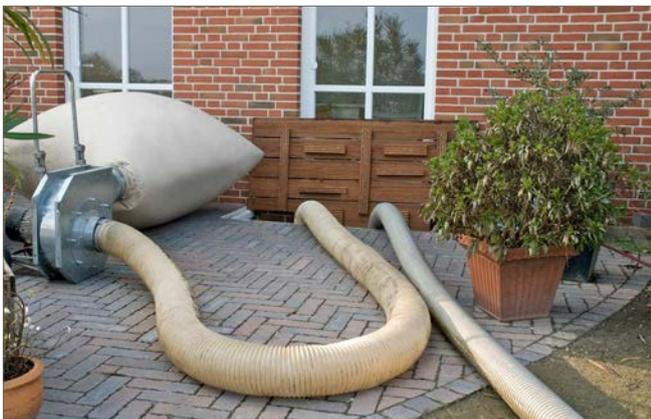
Abb. 3: Absaugventilator mit Staubsack
